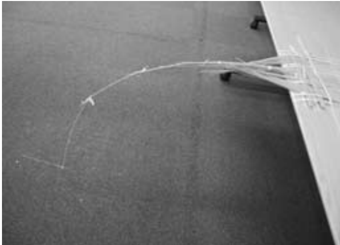
2回目に優勝した作品。元の部分を十分補強し、先端は1本のスパゲッティを足すなど、1回目の反省点をもとに記録を作った
